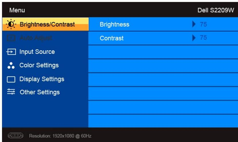
**NOTA:** L'opzione regolazione automatica è disponibile solamente quando si utilizza un connettore analogico (VGA).
