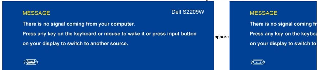
Se viene selezionato l'ingresso VGA o DVI-D e tutti i cavi VGA e DVI-D non sono collegati, appare una finestra di dialogo come quella visualizzata di seguito.
