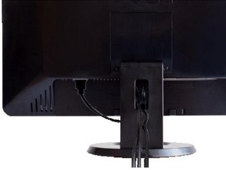
Dopo aver collegato tutti i cavi necessari al monitor e al computer (vedere la sezione di [Collegamento del monitor](#)), utilizzare il portacavi per sistemare tutti i cavi come illustrato sopra.
