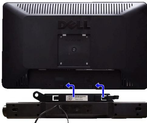
1. Operando sul retro del monitor, collegare la Soundbar allineando i due slot alle due alette lungo il lato posteriore del monitor.
